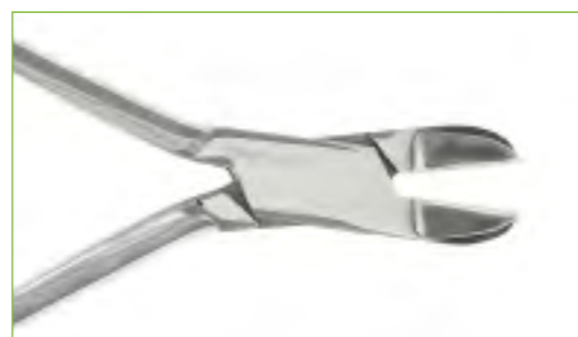
Boční štípací kleště polokrátké Obj. č.: PIN011 Poniklovaná ocel – částečně zarovnané uštipnuté konce Řezný výkon: polotvrký mandal Ø 1,5 mm △ 100 gr – ► 140 mm
